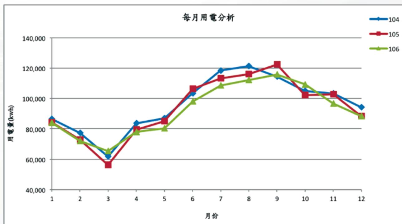
▲ 僑務委員會透過清洗空調管線及汰換照明燈具為 LED 省電燈具等方式，輔以每月用電分析，全力達成能源節約之目標。
